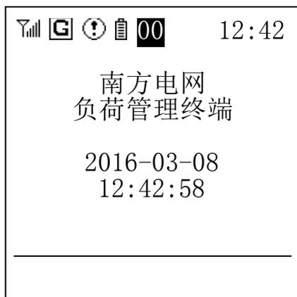
显示屏为 160\*160 单色点阵液晶屏。显示内容主要分为状态栏和内容栏。如图所示最上边的为状态栏，第一个图标表示的是 GPRS 信号强度，可显示 5 级信号强度等级；第二个图标是上线标志“G”，终端成功登录上主站之后就会显示出来；第三个图标是告警标志，通过设置重点事件记录参数之后，出现重点告警事件，标识会显示出来；第四个图标是电池剩余电量。
